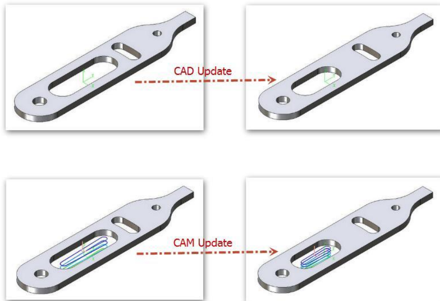
Rysunek 4: Aktualizacja CAD jednocześnie aktualizuje CAM
